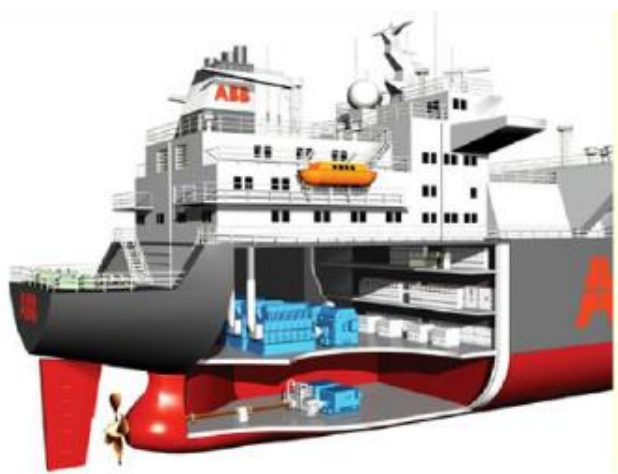
Figura 2 - Posição do MCP em um Navio
