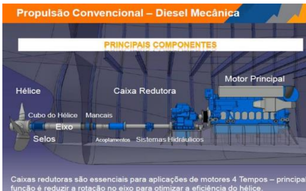
Figura 3 - Principais Componentes de um Sistema de Propulsão Convencional
